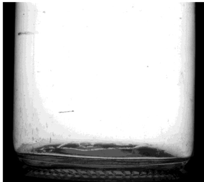
由于待检测的异物主要存在两种光学特性分别是吸光特性和反光特性，因此在进行异物检测过程中使用背光光源和底光光源的光照环境。在异物吸光特性较强时使用背光光源检测。反光特性较强时使用底光光源检测。同时通过调节相机和光源、待检测目标之间的相对距离和夹角等几何参数，找到最佳的配合方式。最大限度的避免杂散光线的干扰，提高异物检测的准确性。
