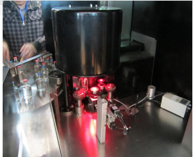
通过前期与合作单位的技术合作，现阶段已经生产出了相应的异物检测设备样机。并通过在实际情况下进行了测试。测试的结果，对于误检率大约为**20-30%**，漏检率**5%**，达到了初步的效果。
