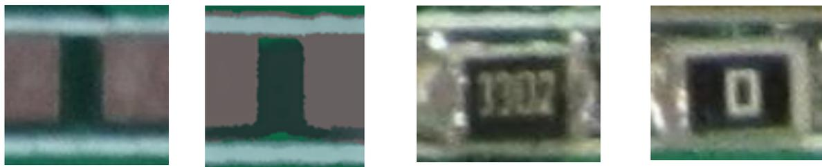
使用空焊点和贴片电阻分别作为正样本和负样本，进行SVM的训练，得到结果。由于SVM的训练速度很快，因此可以快速得到分类器。实际测试中，检测了待测试板上的28个贴片焊点和10个空焊点，并转换不同的角度进行测试，共测试5回，判断准确率为100%。说明可使用此方法对元器件进行快速高效的分类。
